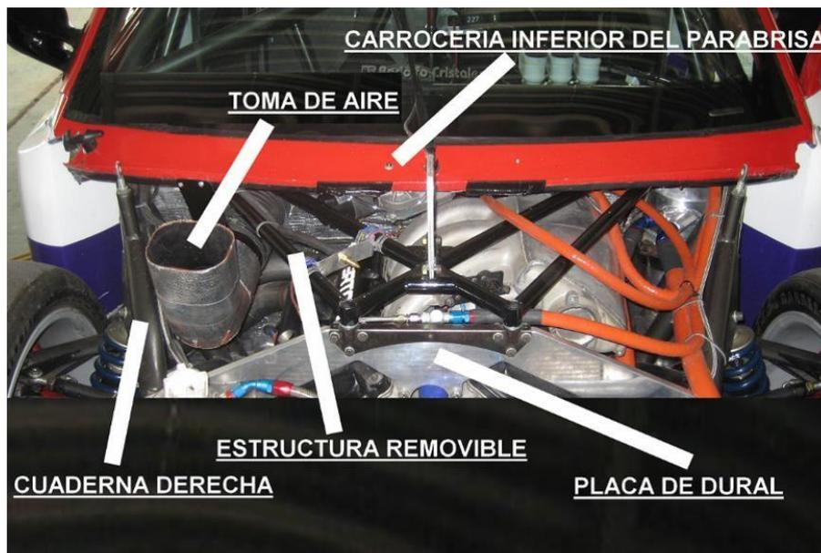
Además, tanto la caja del filtro de aire como el codo de entrada de aire, deben ser los homologados y provistos por la categoría. Permittedose recortar el largo del codo para posicionarlo en el vehículo.
