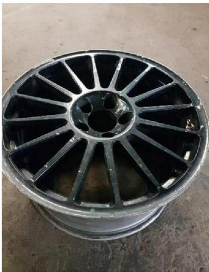
Desplazamiento de este modelo de llanta solo para lluvia es de 184mm con un suplemento opcional de un espesor máximo de 12mm
