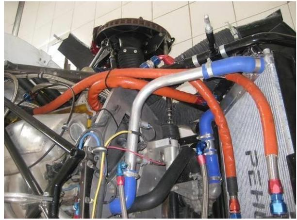
Se debe colocar una estructura de protección del radiador de aceite (ídem fotos), la cual debe tener estar construida con caños de dimensiones mínimas, 32 mm de diámetro y 1,8 mm de espesor.
